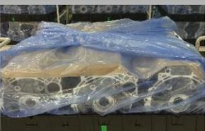
Das Verpackungspersonal muss bei der Handhabung von Metallteilen stets Handschuhe tragen. Teile müssen vor dem Verpacken sauber und frei von Fingerabdrücken sein. Die sauberen Produkte so schnell wie möglich verpacken. Das Teil soll höchstens 30 cm von der Clear Pak 5000-Folie entfernt sein.
